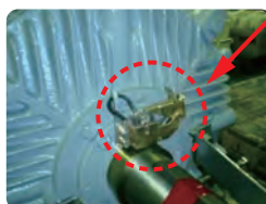
図2 アースブラシ有無による軸電流
