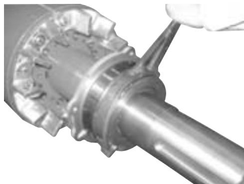
図 16.1 排油ランナ、締付ナットの締付作業
