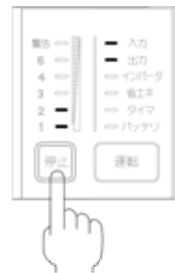
上記LED表示は、正常時のバイパス運転、負荷 50%の場合の例です。
