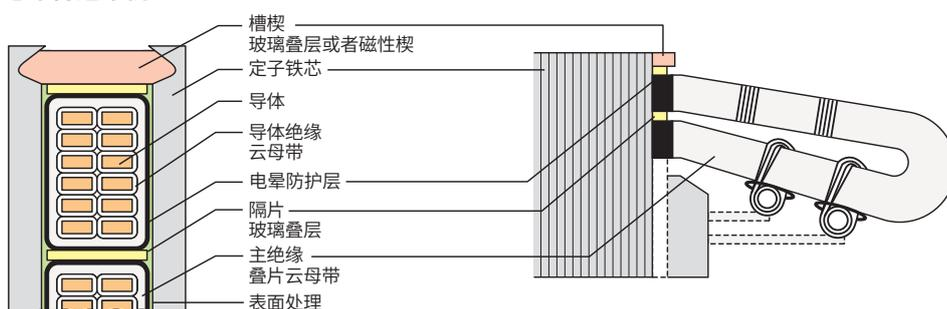
所用绝缘等级和规格取决于逆变器浪涌电压值，以确保高可靠绝缘。使用云母带来防止电晕放电作用，并且有一个特殊区域用于导电电晕保护。
