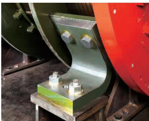
使用有限元方法 (FEM) 等技术，进行模型分析，以便精确地理解自然振动模式，然后将所得信息用于消除电机内因共振引起的振动。对于超高速电机，采用弹性支撑系统来吸收因电磁力造成的定子铁芯振动，同时在宽速度范围内实现低振动。
