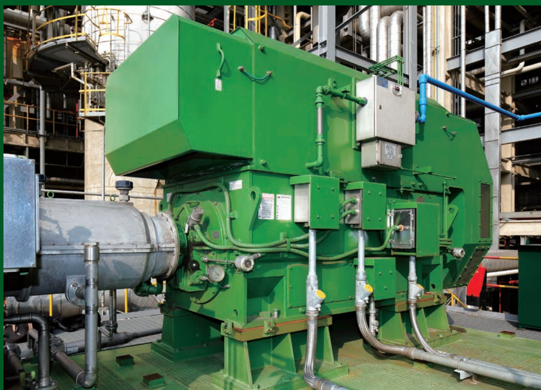
照片：TMEIC变频器驱动的Ex p、4极、1,900kW变频异步电机和由其驱动的压缩机
