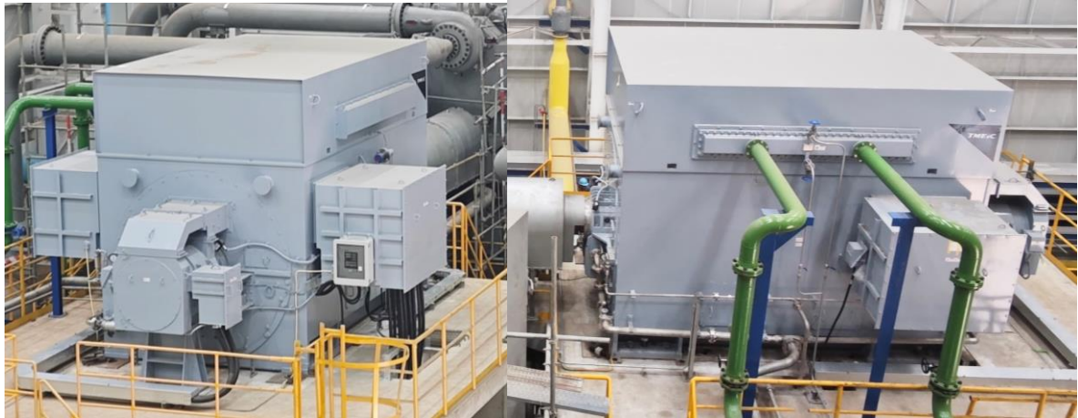
開発した6極大形同期モータ(出力:48.4MW)
