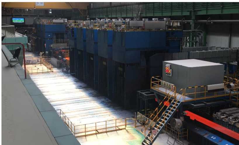
写真：首钢京唐鋼鉄が導入した薄スラブ連続鋳造・熱間圧延設備の様子
