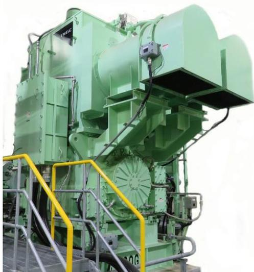
磁気軸受適用超高速モータ
